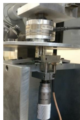
Figura 2 - (a) Esquema do sistema de medição de posição, (b) montagem do sistema de medição de posição.
